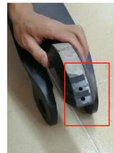
A l'aide d'une clé ALLEN, visser les deux VIS fournies, permettant de maintenir la PLAQUE MÉTALLIQUE B sur le garde boue arrière .
