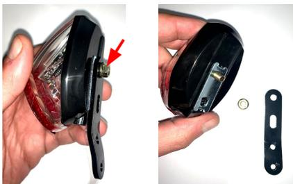
Positionner la PLAQUE MÉTALLIQUE B sur la PLAQUE MÉTALLIQUE A (comme sur les images). Remettre le BOULON à sa place initiale est bien serrer le BOULON.
