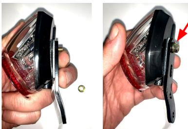
Positionner l'ensemble sur le garde-boue arrière de la trottinette 4FLEX. Faire une marque sur le garde-boue afin de bien positionner les VIS.
